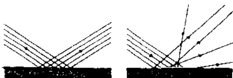
左：平滑的表面将一束光线整个朝一个方向反射出去。右：粗糙的表面使光线散射。
