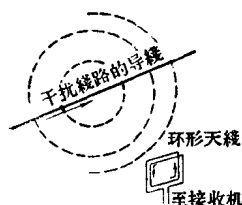
圖 1-5. 环形天线与干扰线路间的电感耦合。
