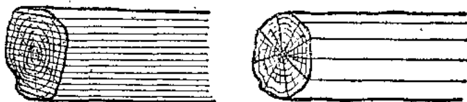
第一圖 由邊皮鋸起的木材 第二圖 由四等分處鋸起的木材
