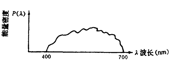
图 1-1 某种颜色的光谱能量分布
