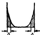
图1 高频电流在直导体上的分布。
