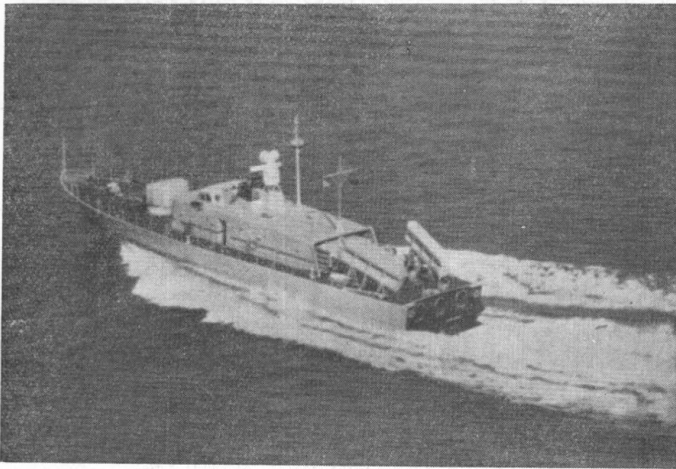
图1-4 英国“坚韧”级快速护渔巡逻艇，基本上是一种滑行艇。它是滑行艇型中吨位较大的艇例，艇长142英尺，采用燃气轮机驱动，能够达到40节航速。该艇原始打算设计成一艘舰对舰导弹快艇。
