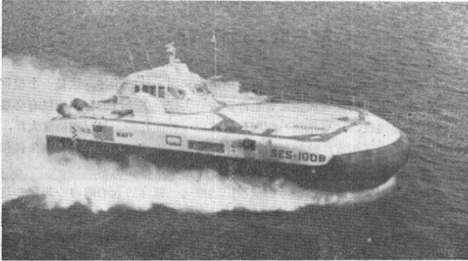
图1-1 一艘100吨级气垫船，是一艘正在试航中的全垫升气垫船。这种船被支承在靠内部导管风扇供应的较低压气垫上，它们是靠涡轮传动的喷水推进器推进，潜在的最大航速达80节。
