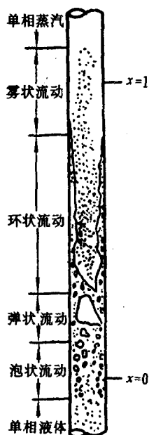
图 1-2 加热的垂直上升管中的流型
