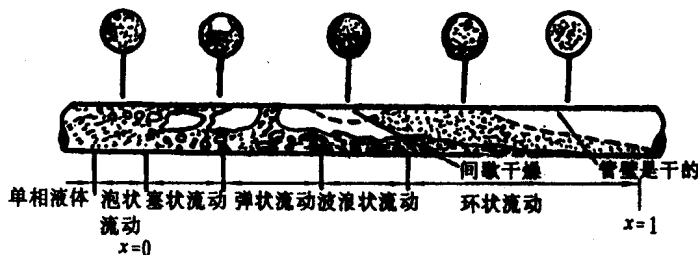
图 1-4 加热的水平蒸发管中的流型
