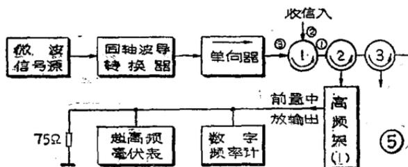
⑥让对方站关掉发信机，调整图5中微波信号源输出电平为 $A(\text{dBm})$ ，频率为所测波道的收信频率（此频率的准确度，可用图中的数字频率计监测中频检查），用超高频毫伏表测得此时前置中放的输出电压值 $B_m \text{V}/75\Omega$ 。
