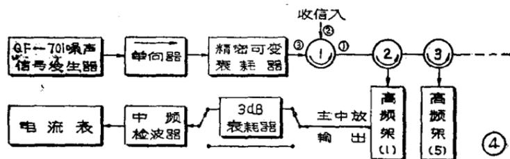
图 4 测得的接收机噪声系数可按下式计算：
