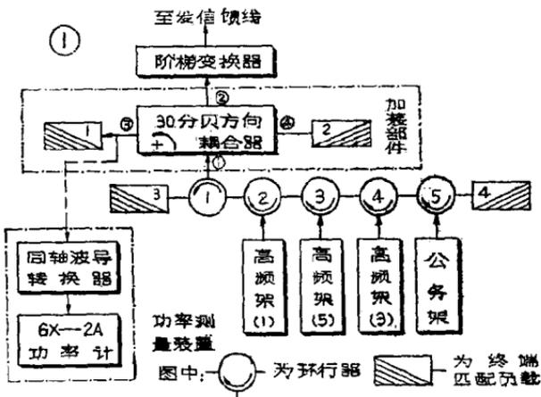
(2) 每当发信功率测试完毕后，应重新接上终端匹配负载。
