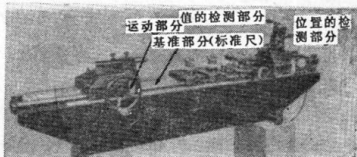
图2 测长器[卡尔·蔡司 (Carl Zeiss) 公司制]的结构部分
