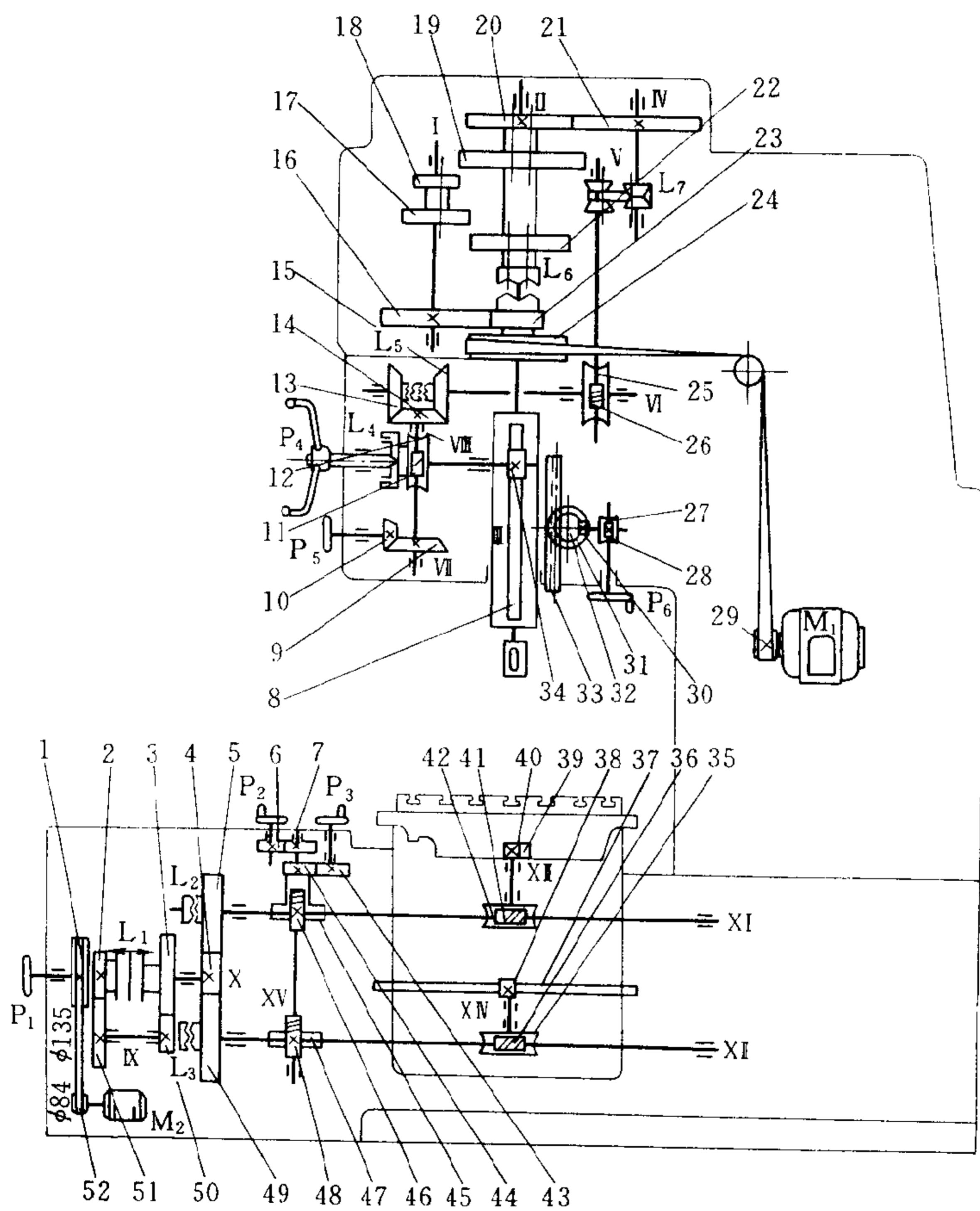
图 1-3 T4163 型单柱坐标镗床的传动系统
