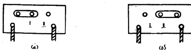
图 2-5 BX1-330 型弧焊变压器的电流粗调节
