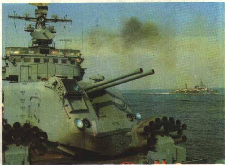
所向披靡——装备在舰艇上的双管大口径舰炮和火箭式深水炸弹发射器
