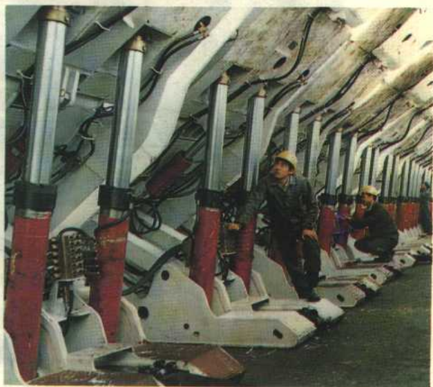
严格检验——最后调试中的矿用液压支架
