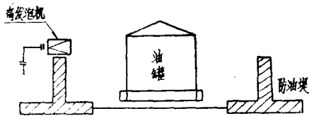
图12 防护油堤示意图
