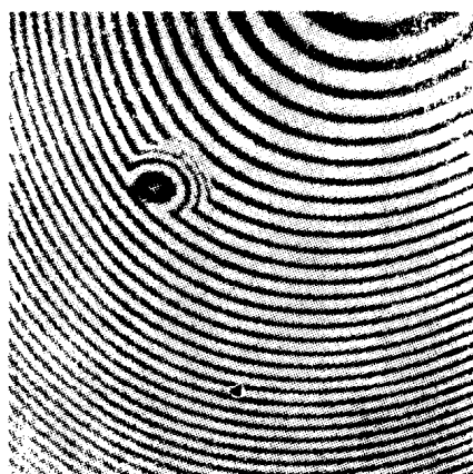
图5 被测物体镀层厚度 d=0.02 毫米，附着力缺陷直径 D=10 毫米时的全息检测结果
