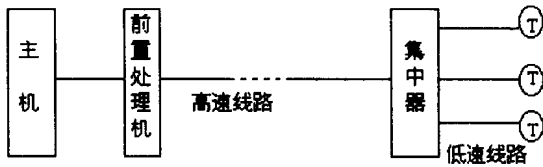
图 1-2 具有通信功能的多机系统
