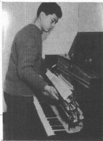
图 15 取下击弦机,注意中间螺杆不要碰坏止音呢;取下击弦机后放在长桌上,不要使中间机件受压
