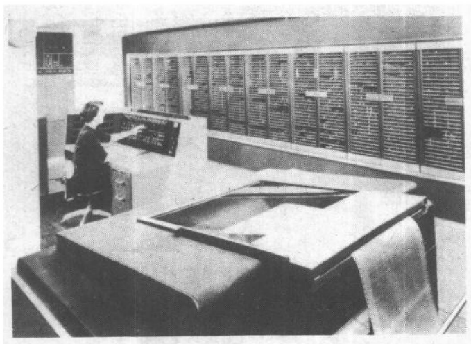
图1.2 五十年代中期功能最强的计算机是海军军用研究计算机，它包括了9000个电子管
