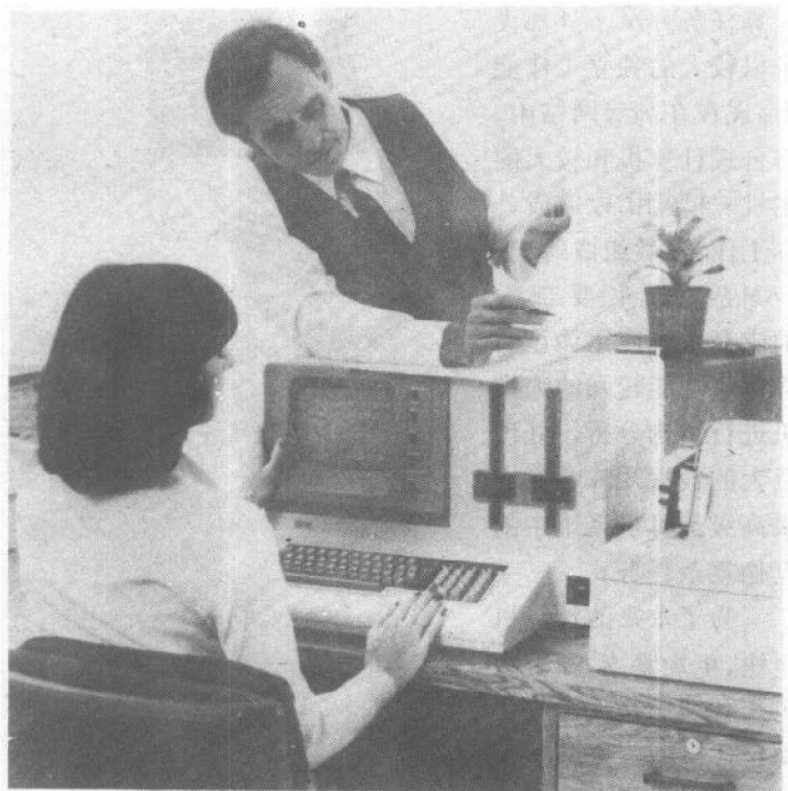
图1.5 IBM 5120型台式计算机，具有20年前可放满一个 20 \times 30\text{ft} 房间，重 1 ton 的设备的功能
