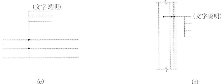
图 1-15 多层共用引出线
