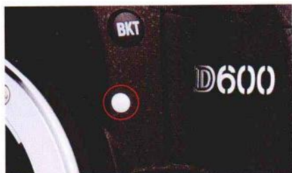
▲安装Nikkor镜头时，先把镜头上的白点对准机身的白点。
