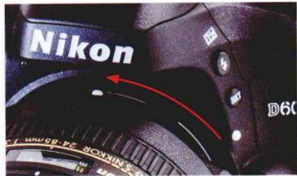
▲然后小心地把镜头插入机身接环内，再逆时针方向旋转镜头并将其锁紧在机身上。
