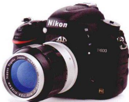
▲尼康D600所使用的F接环源自1959年面世的尼康F，当时的Nikkor镜头仍然可以安装在今天的D600上。
