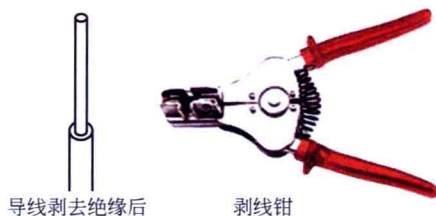
图1-1 用剥线钳剥去导线绝缘层
