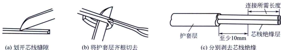
图1-3 用电工刀剥塑料护套线绝缘层
