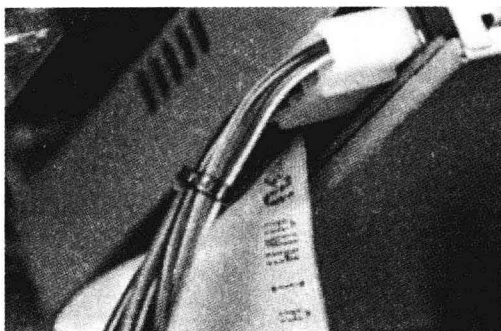
图 1-7 光驱的数据线与电源线
