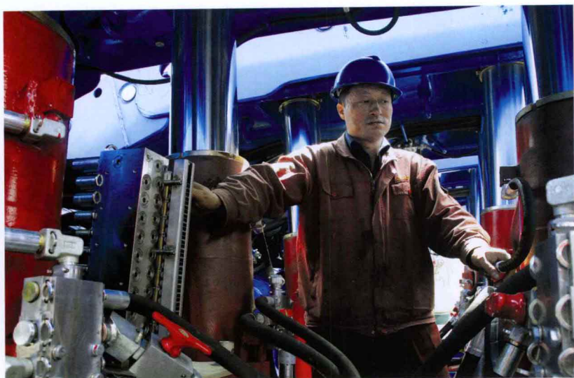
支架分公司员工在调试 ZF8600 电控液压支架
