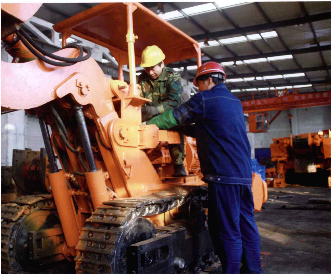
矿机修造分公司员工在组装侧式装岩机
