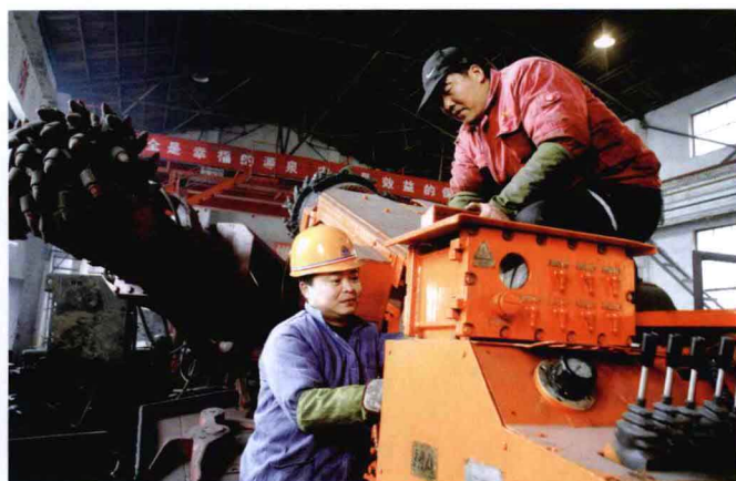
矿机修造分公司员工在修理掘进机
