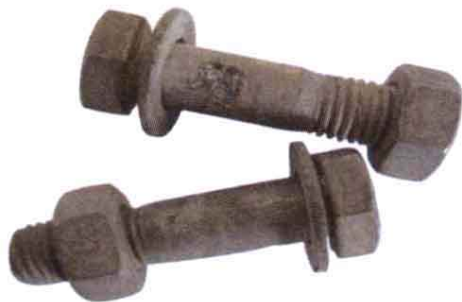
图 1-5 螺栓被电弧灼伤
