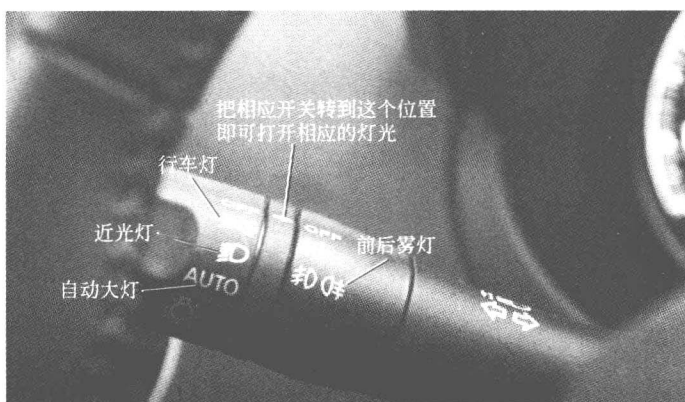
图1-5 拨杆式灯光开关
