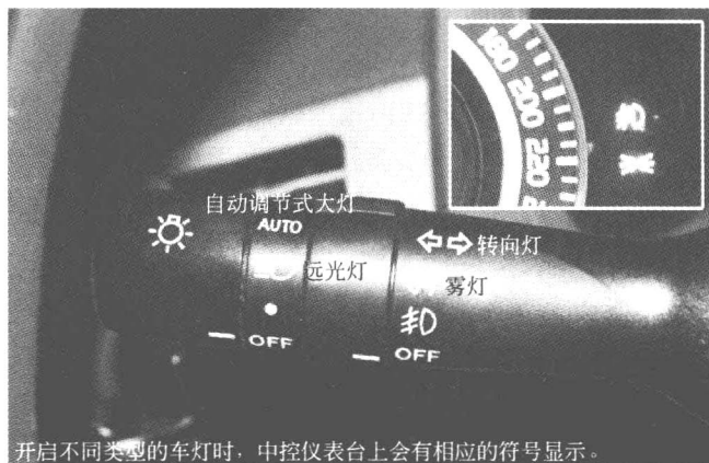
图1-7 中控仪表台上的车灯开关符号显示
