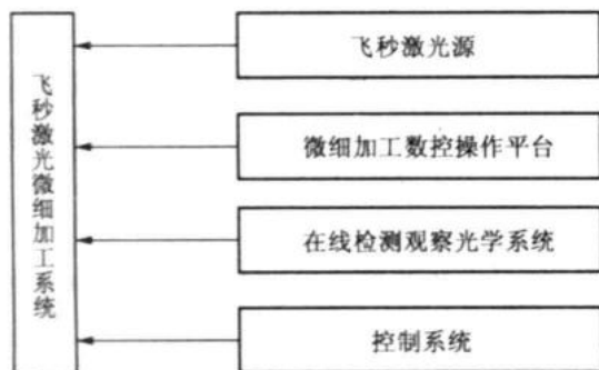
图 2-1 飞秒激光微细加工系统的组成
