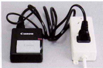
▲ 在给电池充电时,要确保电池的触点与电源金属触点完全接触,充电时充电器指示灯呈红色,充电完毕时充电器指示灯显示为绿色。
