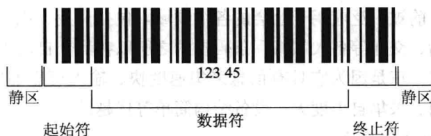
图 1-2 条码符号的构成
