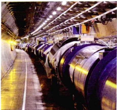
位于瑞士日内瓦近郊的欧洲核子研究组织，拥有目前世界上最大的粒子加速器——“欧洲大型强子对撞机”。它被安装在地下100米深处1个周长27千米的圆形隧道内，于2008年9月10日正式投入运作。它是一种能将质子加速后对撞的高能物理设备，质子在其中可以被加速到接近光速。
