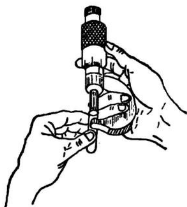
图 1.10 用单手使用外径千分尺
