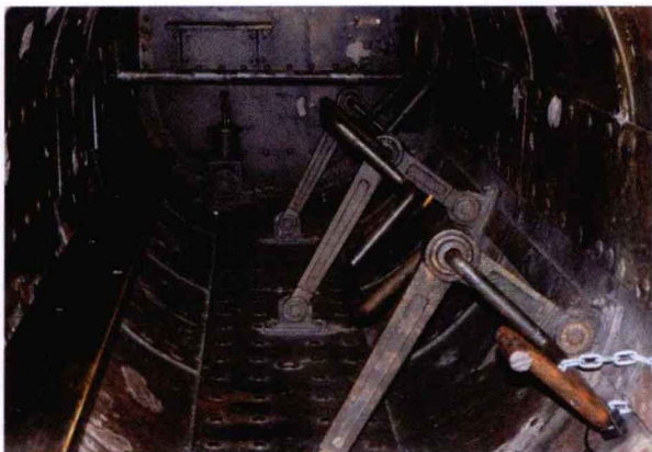
“亨利”号的内部结构中有用于人力推动的曲柄轴。
