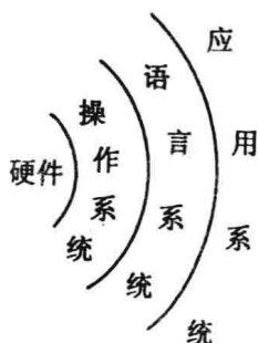
图 1-1 计算机硬件与软件之间层次关系图
