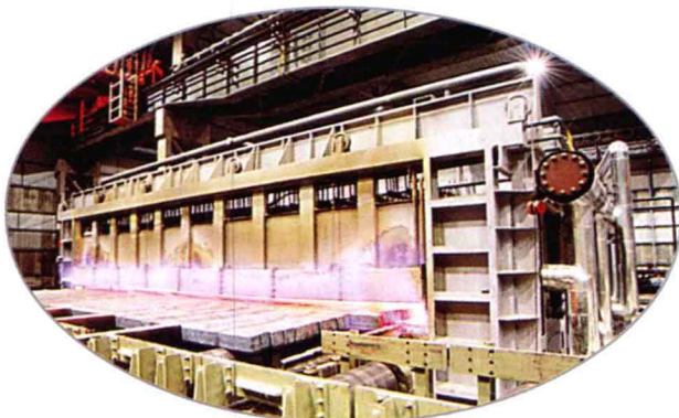
高速线材生产线采用全煤气蓄热式推钢加热炉
