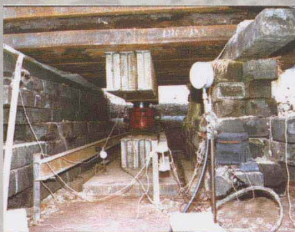
1999年8月豫北院联合中国建科院对基础工程处创新技术《石灰粉喷桩》桩顶进行技术测试, 获得成功
