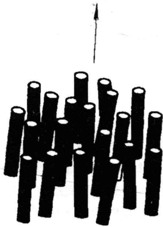
图 1-5 向列型液晶棒结构的排列示意图
