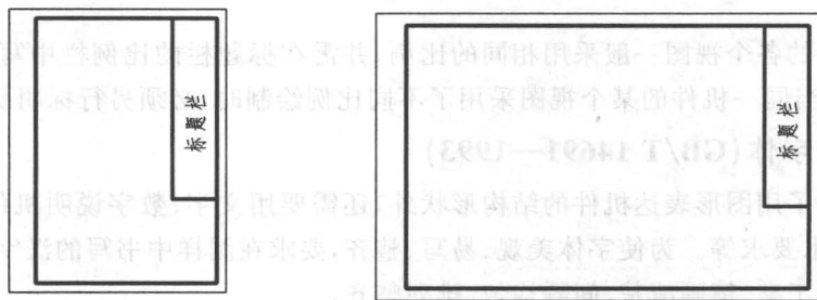
图 1-7 用印制图纸时允许的另一种标题栏方式
