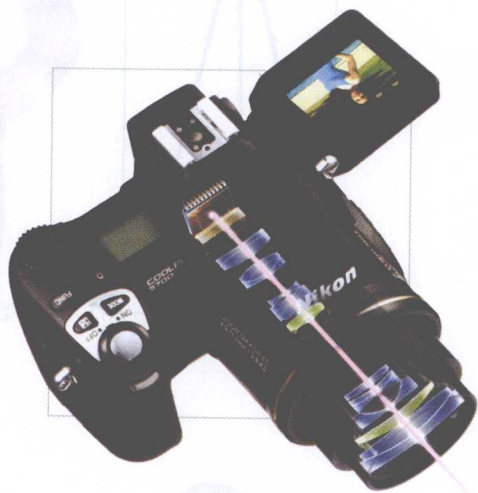
图1—5 轻便型数码相机结构示意图 艳清提供
