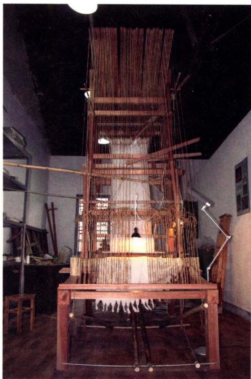
彩图23 用于对龙对凤纹锦复制 的省蹶式多综提花机
