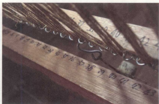
彩图19 省踞式多综提花机上的铁圈和活套
