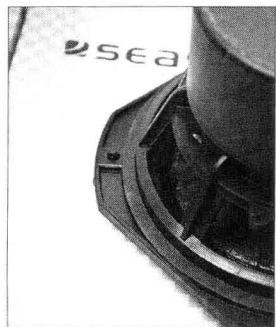
图2.5 低音单元的背面已经贴上密封条了
