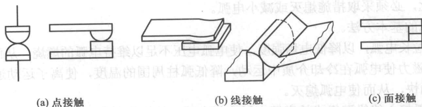
图 1.7 触点的接触形式
