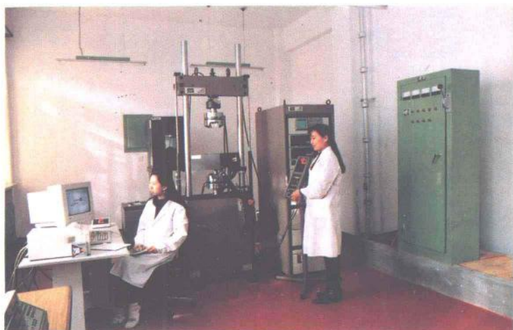
▶ 工业装备结构分析国家重点学科实验室装备的90年代最新的10吨液压伺服材料试验机
