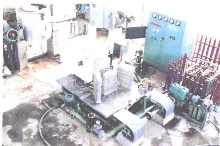
▶ 国家计委、国家教委批准试办的铸造工程研究中心新建的电磁铸造中试装置及其试验产品
