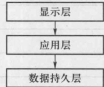
图 1.1 锅炉温度显示的软件层次架构设计
