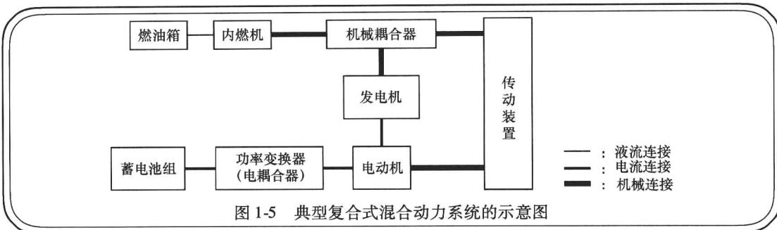
图 1-5 典型复合式混合动力系统的示意图
