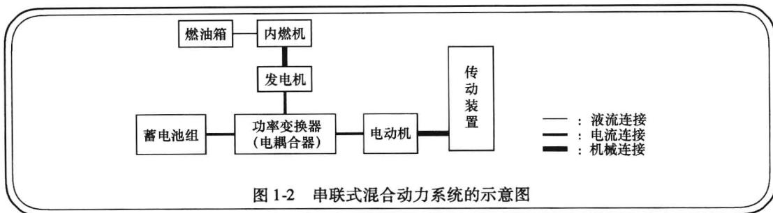
图 1-2 串联式混合动力系统的示意图
