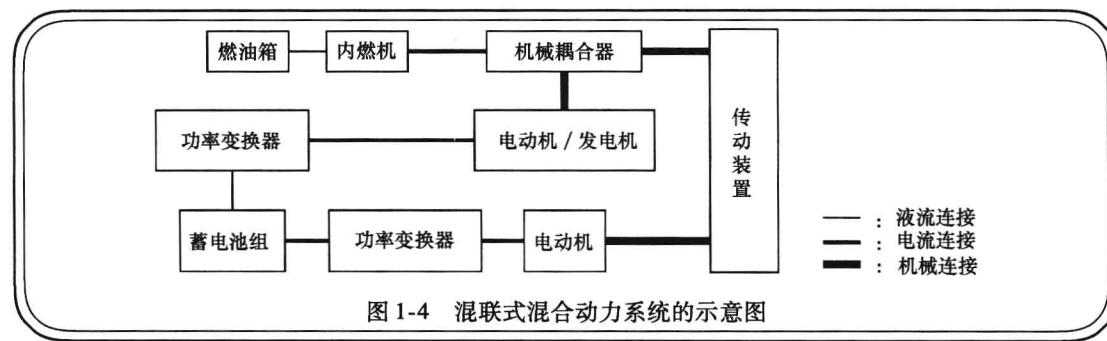
图 1-4 混联式混合动力系统的示意图
