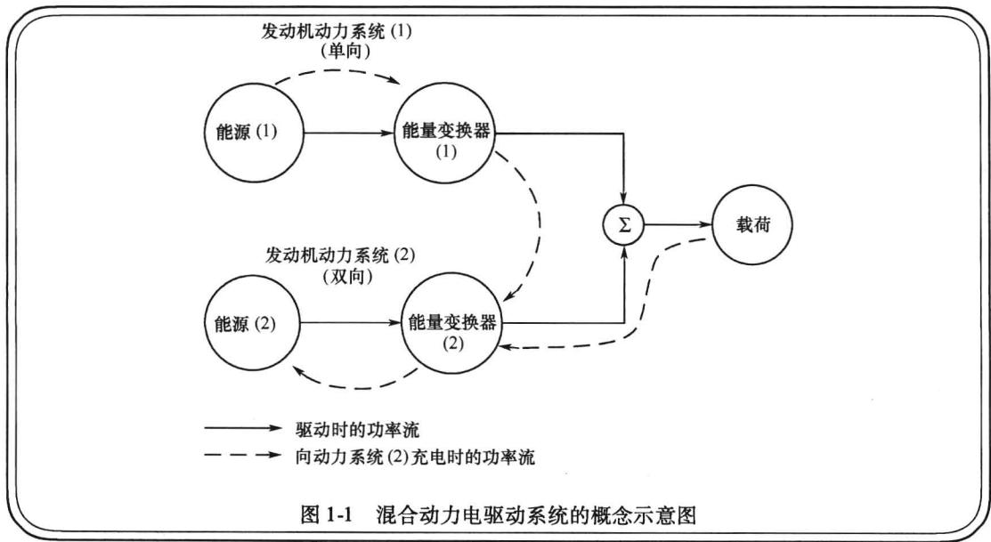
图 1-1 混合动力电驱动系统的概念示意图
