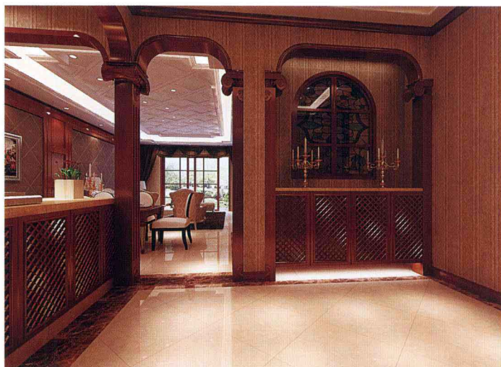
◎ 墙面 / 墙纸 + 装饰窗 + 木质罗马柱 地面 / 抛光地砖斜铺 + 波打线
