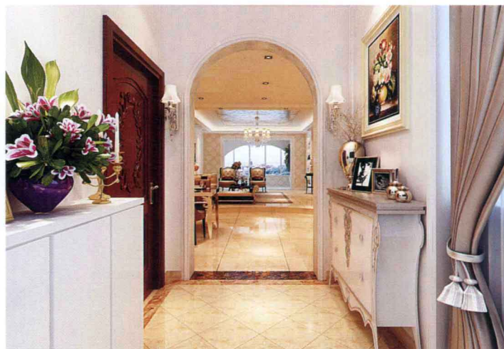
◎ 地面 / 仿古砖斜铺 + 波打线
