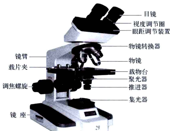
图 1.1 普通光学显微镜的基本构造
