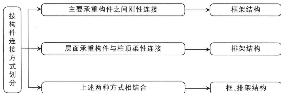
图 2-6 建筑物结构形式与构件连接方式的关系
