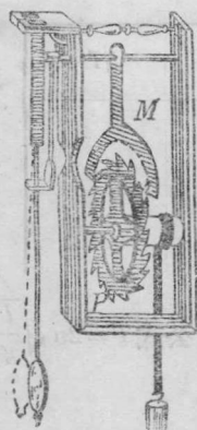
圖 5 用擺調節鐘的運動
