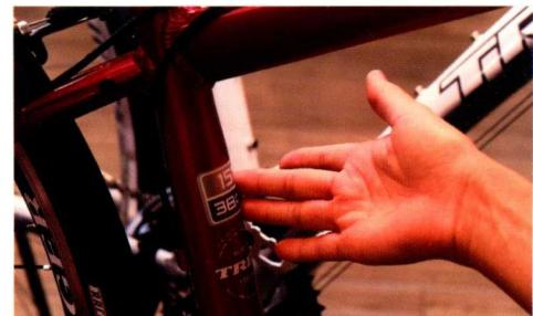
车架尺寸是以支撑车座的座管长度区分。FX共有4种尺寸，可提供身高150cm至180cm的人选用。
