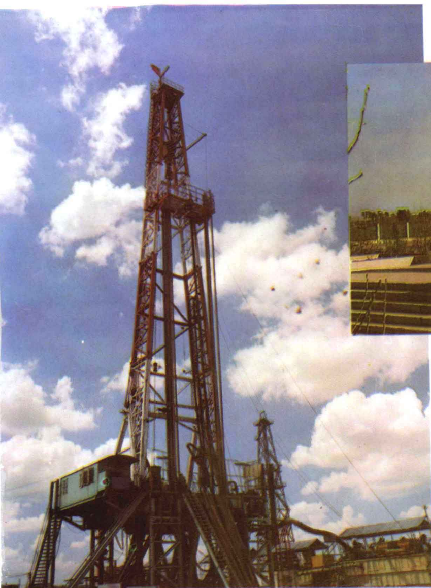
我国自制的第一台电驱动 IJ45D 型钻机在中原油田工业性试验
