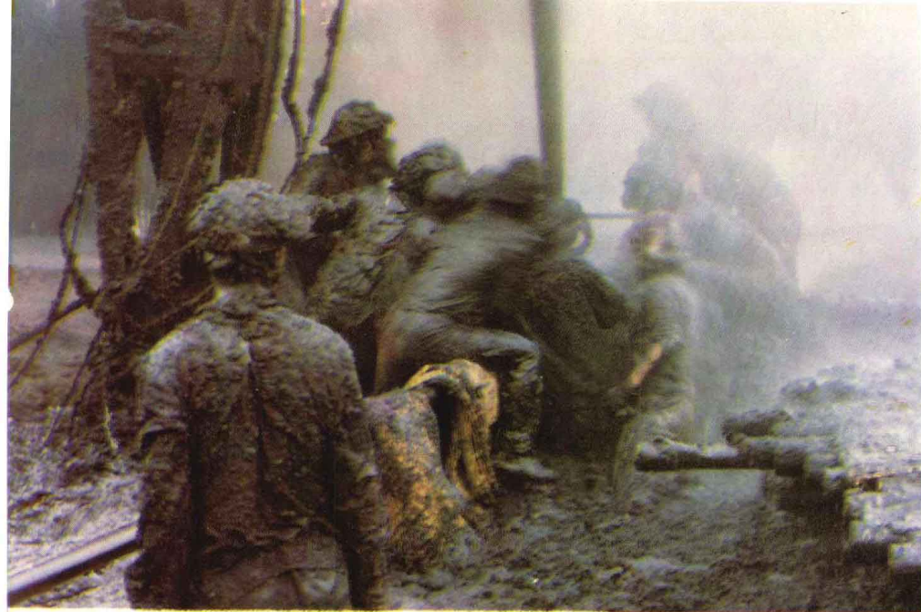
修井工人冒喷作业
