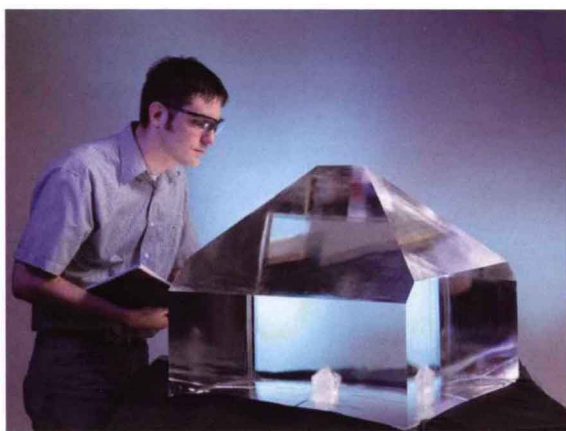
用磷酸二氢钾晶体转换激光束
