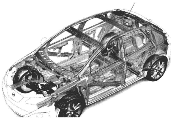
图 1-13 承载式车身结构
